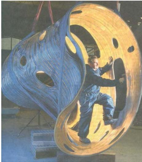
Wer jetzt aber glaubt, der Stellerator wäre komplett in sich geschlossenes, der irrt gewaltig. Insgesamt 299 Löcher lassen ihn wie einen Schweizer Käse wirken. Mehr war nicht möglich, da jeder Durchbruch aufwendig wärmeisoliert und luftdicht mit der Außenhülle verbunden werden muss. Durch diese Löcher werden später im Betrieb Forscher und Studenten das Hochtemperaturplasma im Betrieb beobachten und erforschen können. Hier noch ein Bild eines maßstabsgetreuen Modells:
